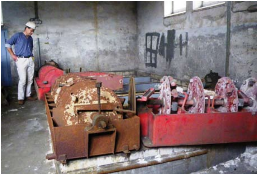
Abb. 9.6.b: Becherschöpfwerk-Dosierer, im Bild Stefan Dützer, Foto 2012
