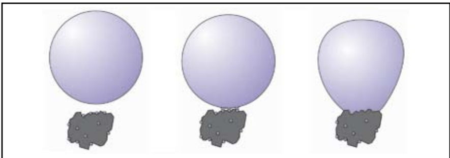
Abb. 5.5.b: Anziehungskraft durch Brückenbildung zwischen mikroskopisch kleiner Luftblasen auf der Partikeloberfläche und größeren Luftblasen in der Trübe, Prinzipskizze
