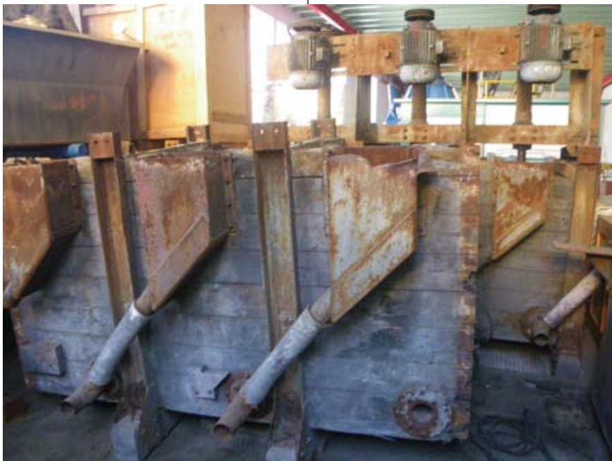
Abb. 5.5.c: MS-Zelle, Ablassseite, heutiger Standort Aufbereitung Antoni in Bleiberg/Kärnten, Foto 2012
