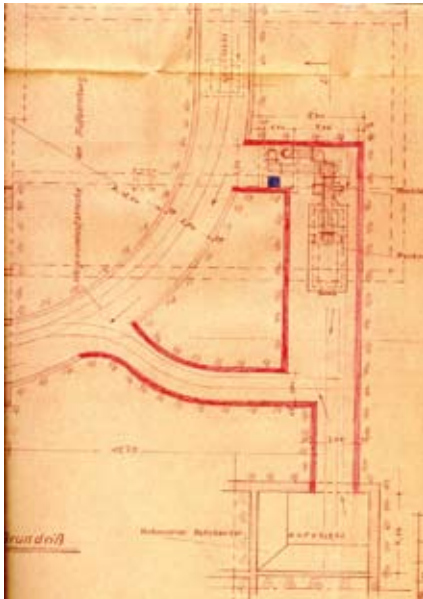
Abb. 10.7.c: Riss der 1943 erbauten Schwerspatflotationsgebäude, Trockner in der U-Bahnhof-Ebene /BAC 1935/
