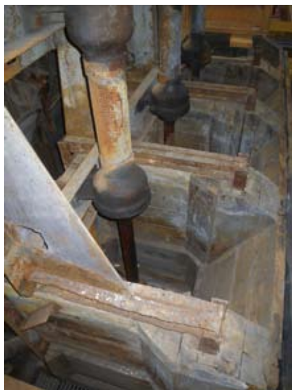
Abb. 5.5.d: MS-Zelle, Schaumabstreiferseite, heutiger Standort Aufbereitung Antoni in Bleiberg/Kärnten, Foto 2012
