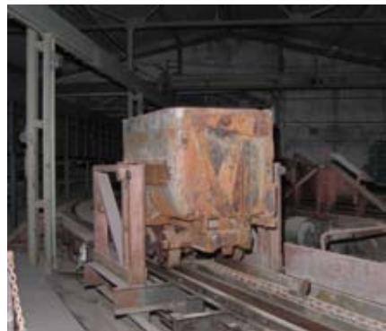
Abb. 9.2.h: Granby-Wagen auf Kettenziehvorrichtung, Foto Stefan Dützer 2010
