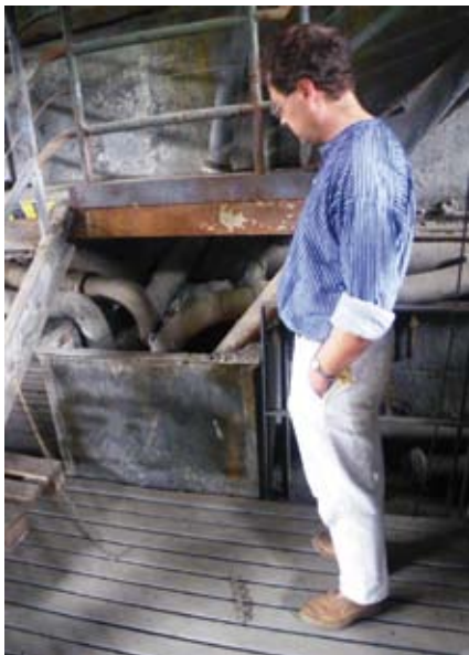
Abb. 9.5.d: Foto Trübesammelbehälter nach den Schüsselklassierern, im Bild Stefan Dützer, Foto 2012
